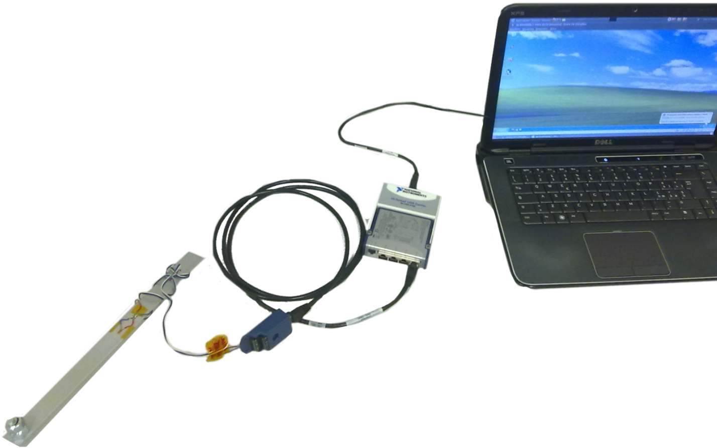
Figure 1: Catena di misura: da deformazione elastica a misura numerica digitalizzata
