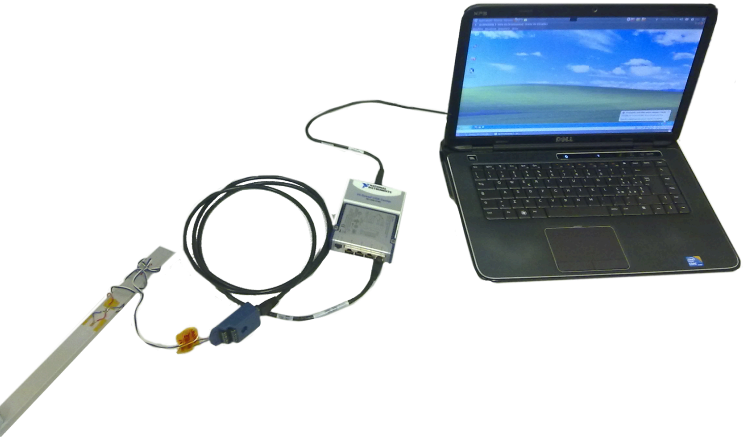
Figure 1: Catena di misura: da deformazione elastica a misura numerica digitalizzata
